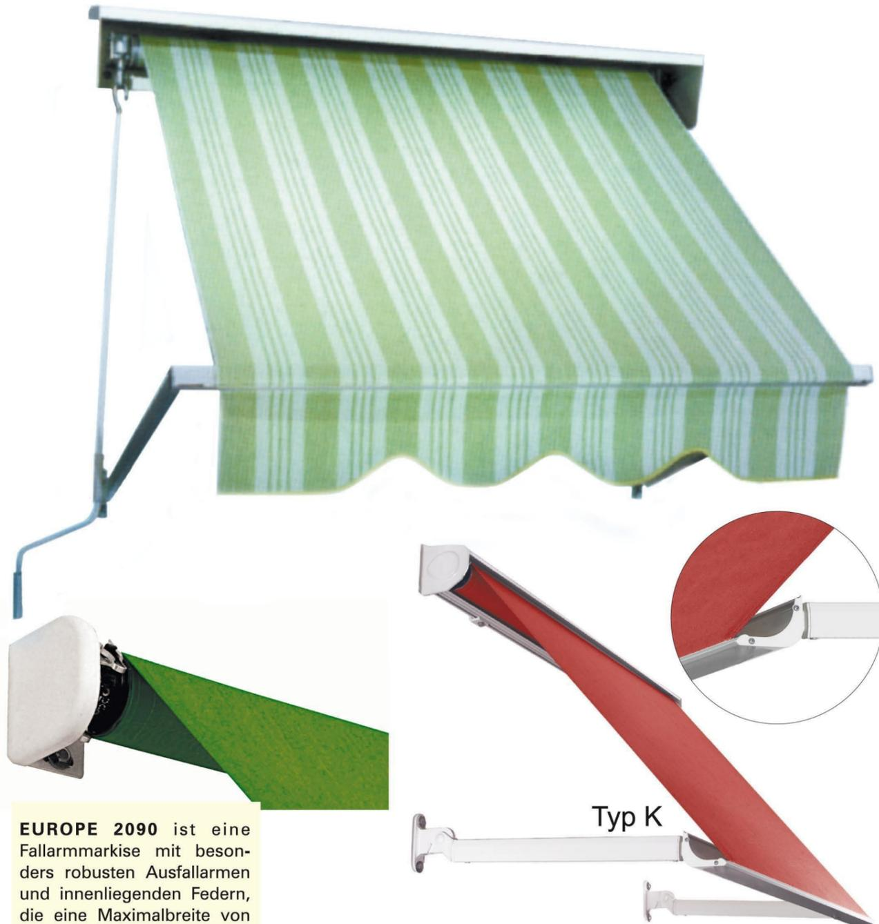
**EUROPE 2090** ist eine Fallarmmarkise mit besonders robusten Ausfallarmen und innenliegenden Federn, die eine Maximalbreite von 600 cm und eine maximale Ausstellung von 175 cm erreicht. Die äußerst rasche Wand-, Decken- oder Nischenmontage erfolgt, indem man die Markise an die bereits bauseits befestigten Konsolen einhakt.
